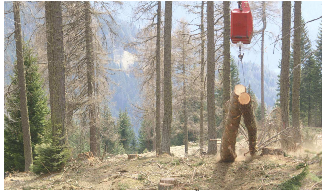
Der Seilkran bringt Stämme mit dünnen Ästen bis zum Forstweg.
